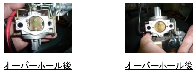
オーバーホール前 オーバーホール後
