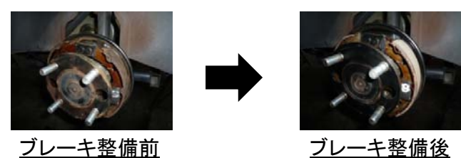
ブレーキ整備前 ブレーキ整備後
